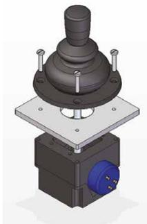
Der Joystick wird von unten montiert. Dazu wird der Gummibalg durch die Bohrung in der Montageplatte geführt und gegen die Stirnseite gepresst. Die Verschraubung erfolgt durch die Abdeckung.
